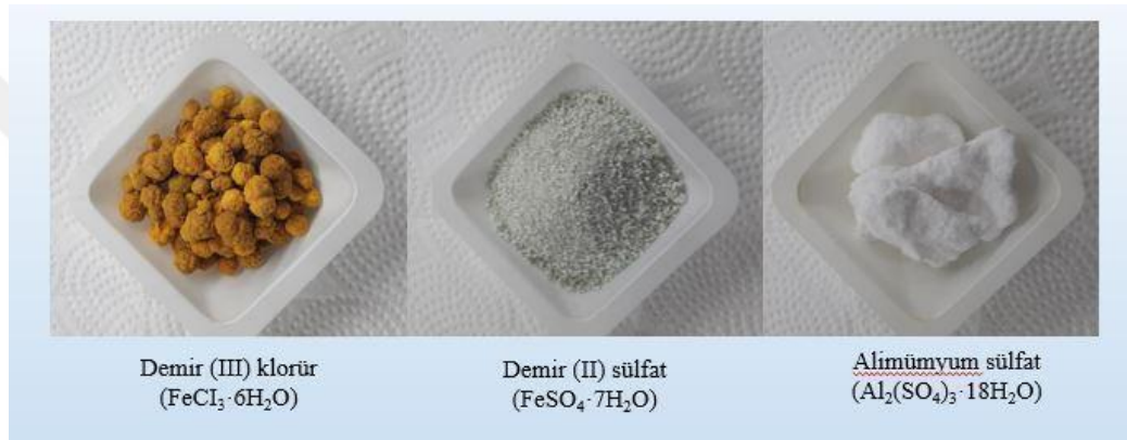
Şekil 3.3. Koagülasyon flokülasyon prosesinde kullanılan koagülantlar.
