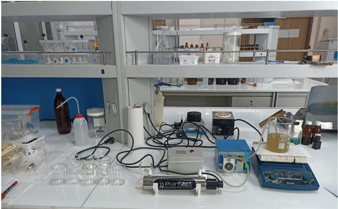
Şekil 3.6. Otomotiv endüstrisi boyama prosesi atık suyu arıtımında kullanılan UV/ H_2O_2 prosesi deney düzeneği.
