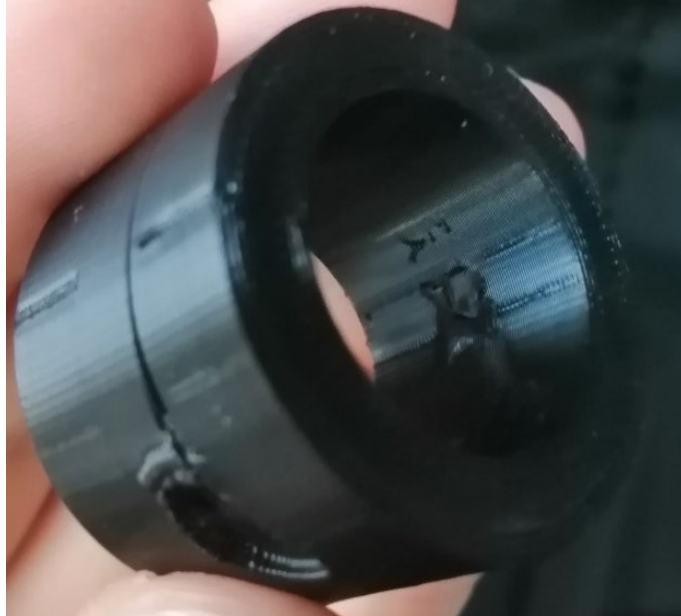
Şekil 4.11 0.9 m/s hızda yapılan deneylerde petg filamentinin deformasyon görüntüsü
