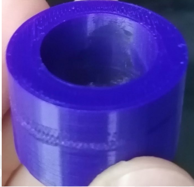
Şekil 4.10 0.9 m/s hızda yapılan deneylerde pla+ filamentinin deformasyon görüntüsü
