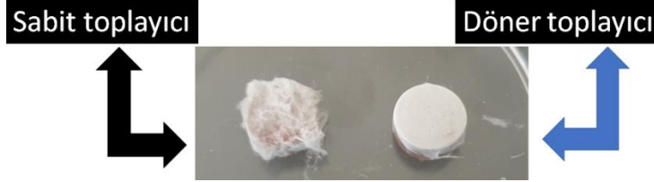
Şekil 4.10. Nikel yüzeylere PSU-Nf ile kaplama yapılması için en uygun toplayıcının seçilmesi
