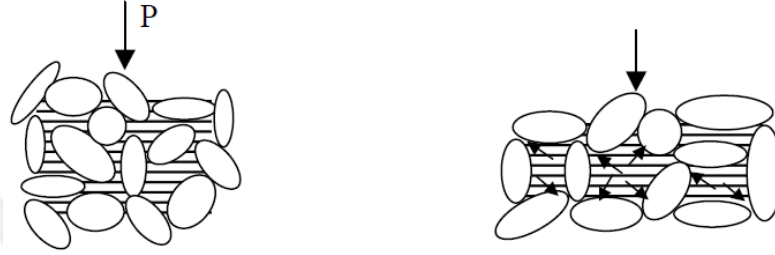
Şekil 3.3. Doygun zeminlerde ek boşluk suyu oluşumu (Çinicioğlu, 2005)
