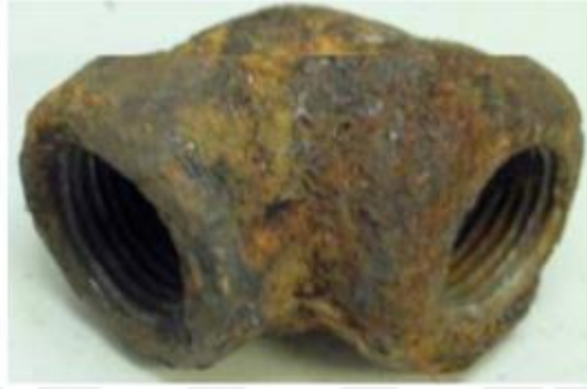
Şekil 1.9. Çelik bağlantıda tek tip korozyon türünün gösterimi.
