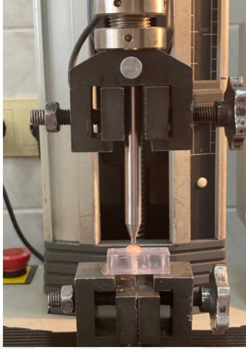
Şekil 3.8: Bağlanma dayanımında kullanılan push -out cihazı
