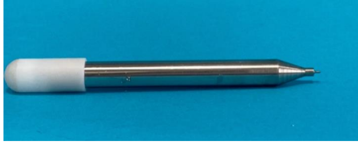
Şekil 3.7: 0.9 mm çapındaki itici uç
