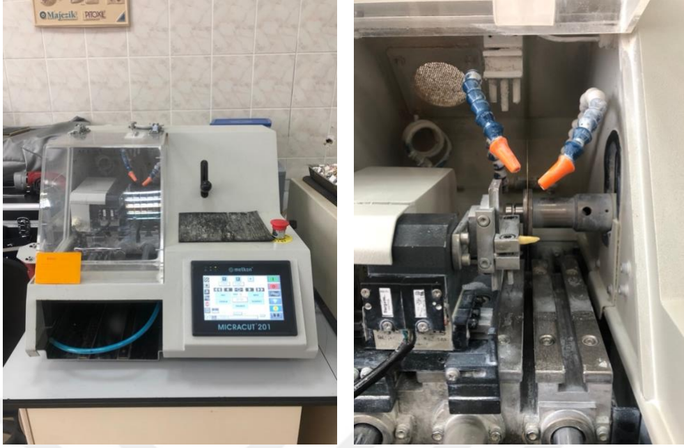
Şekil 3.1: Hassas kesim cihazı ile dişlerin kuron bölümlerinin uzaklaştırılması
