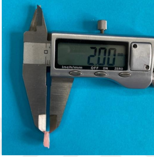
Şekil 3.6: Apikal bölgeden alınan kesitlerin kalınlığının kumpas ile ölçümü
