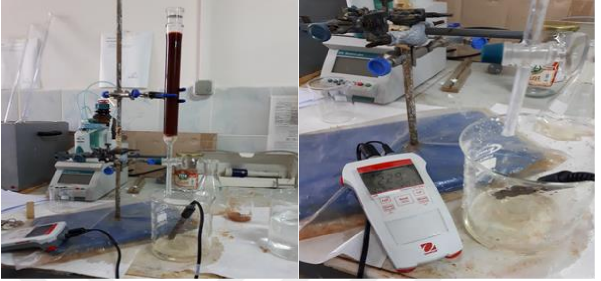
Şekil 13. %8' lik hazırlanan sodyum silikat çözeltisinin reçineden geçirilmesive pH kontrolü
