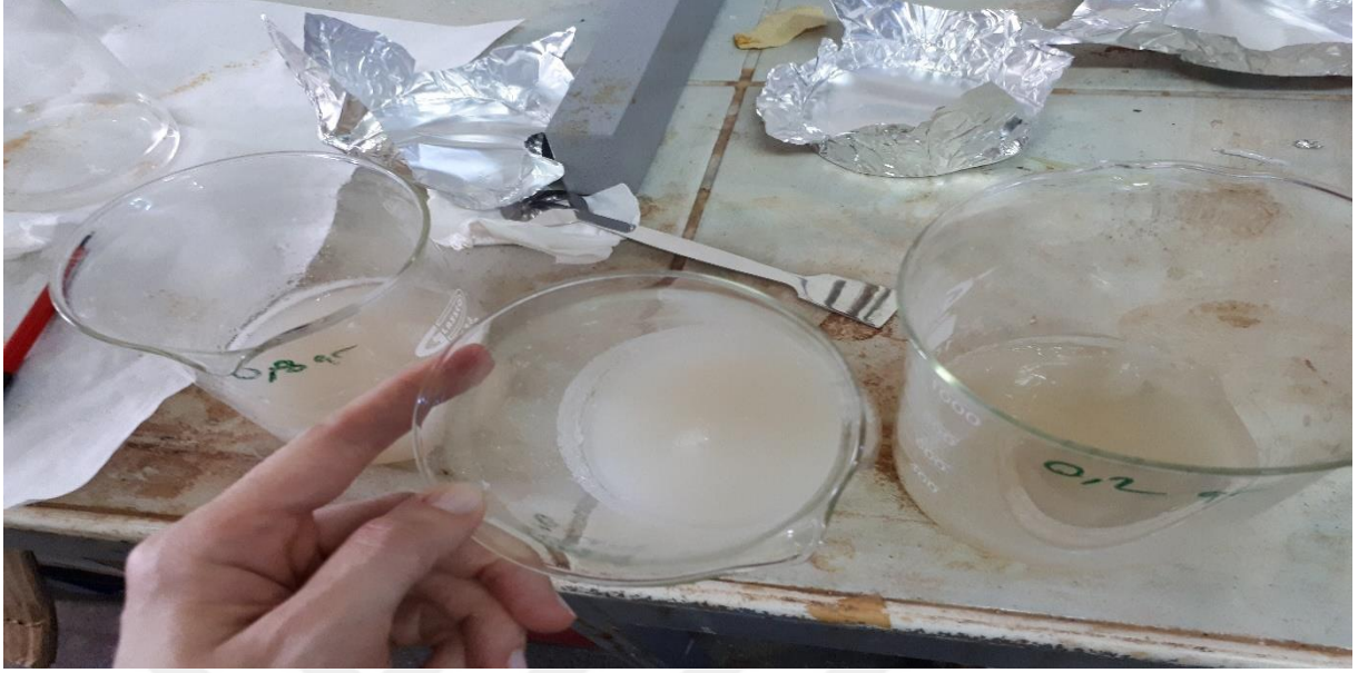
Şekil 18. %2,5 kitosan içeren silika aerojel
