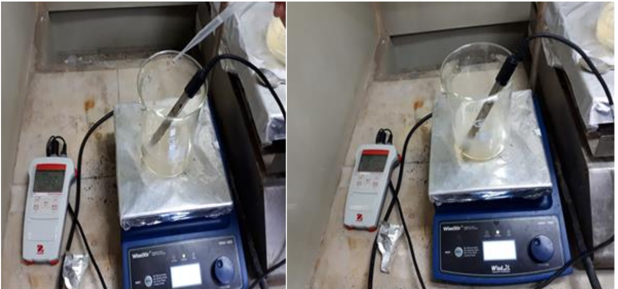
Şekil 15. Seyreltik H_2SO_4 ilavesi ile pH ayarı
