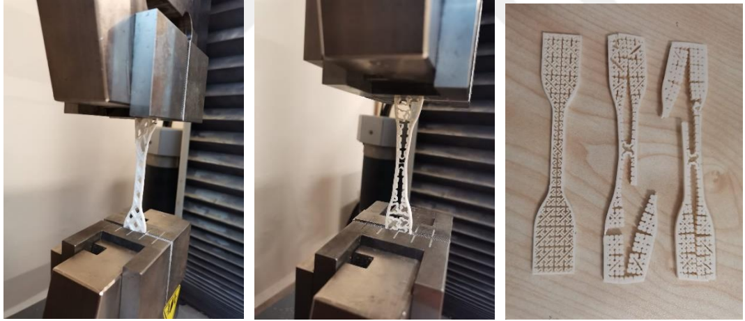
Şekil 4.7. Çekme deneyinin uygulanması ve numunelerin son hali.
