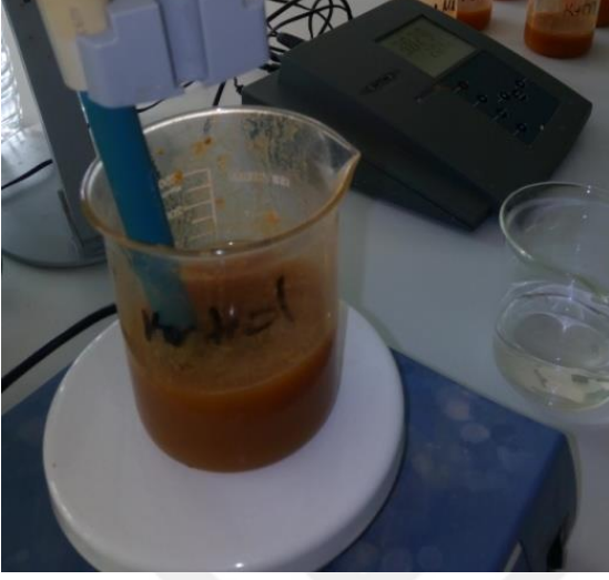
Şekil 10. Dijital pH-metre yardımı ile meyve suyunun pH ölçümünün görünümü
