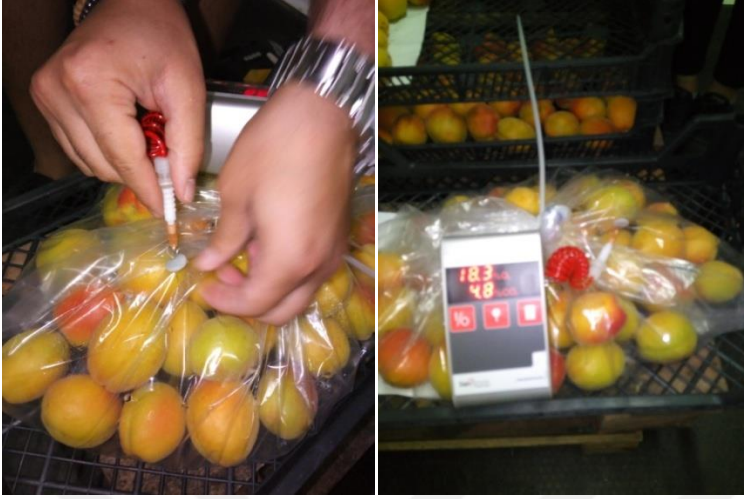
Şekil 15. MAP içi hava bileşeni ölçümünden görünüm
