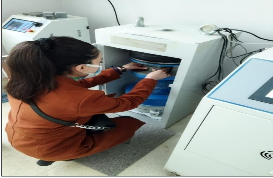
Şekil 3.8. Basınç dayanım cihazında küp numune kırımı.
