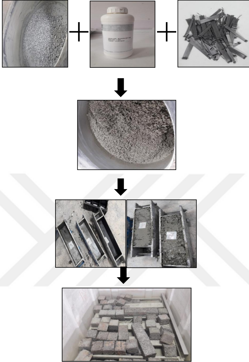
Şekil 3.5. Beton numunelerinin üretim aşamaları.
