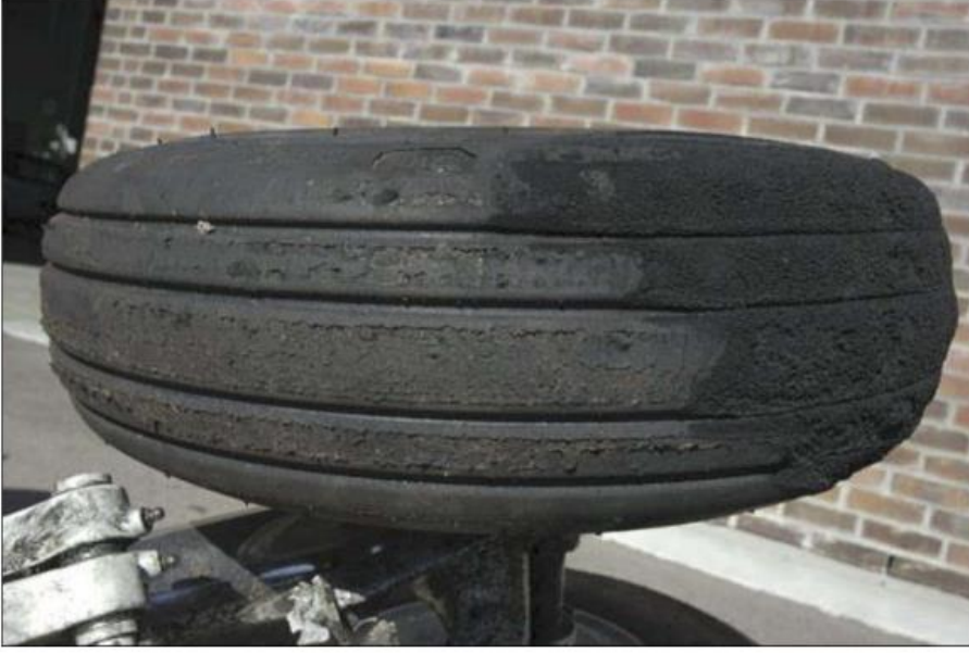
Şekil 2.28: Kazadan sonra lastik üzerinde oluşan kauçuk kalıntıları (Accident Investigation Board Norway, 2012).
