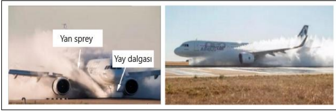
Şekil 2.4: Kızaklama sırasında yan sprej ve yay dalgası oluşumu (Zhang ve diğ., 2020).
