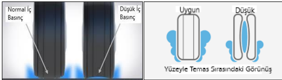
Şekil 2.12: Normal ve düşük iç basınçlarda lastiğin görünümü (url-13 ve url-14).
