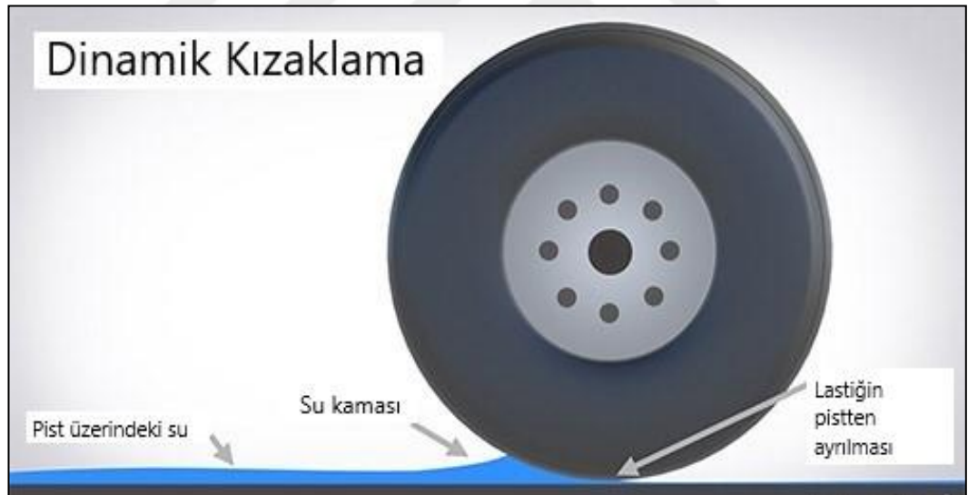
Şekil 2.5: Dinamik kızaklama sırasında tekerleğin durumu ve suyun etkisi (url-13).
