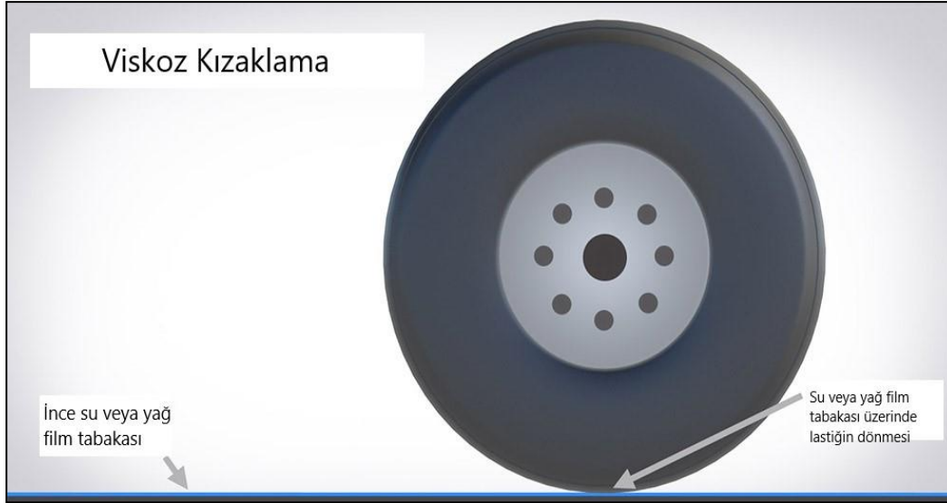
Şekil 2.6: Viskoz kızaklama sırasında tekerleğin durumu ve suyun etkisi (url-13).
