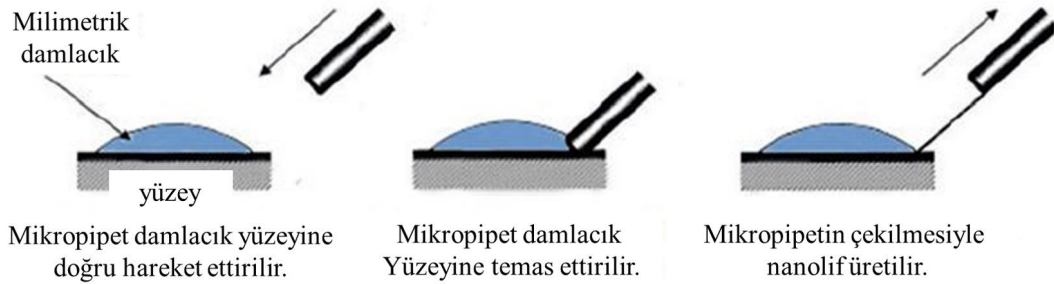
Şekil 1.7 : Lif çekimi yönteminin şematik gösterimi (Referans [32]'den uyarlanmıştır).
