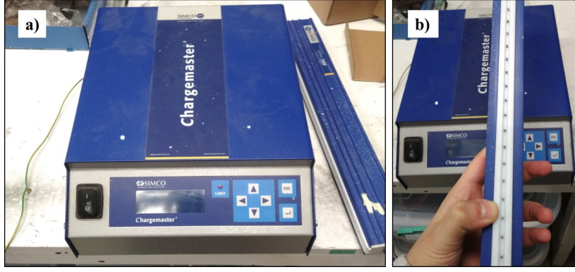
Şekil 2.3 : Korona deşarj sistemi, a) güç kaynağı, b) yükleme elektrodu.
