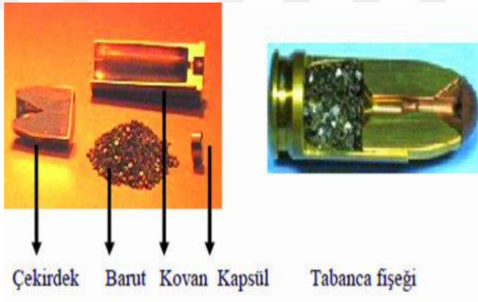
Şekil 2.5. Bir fişegin kesiti
