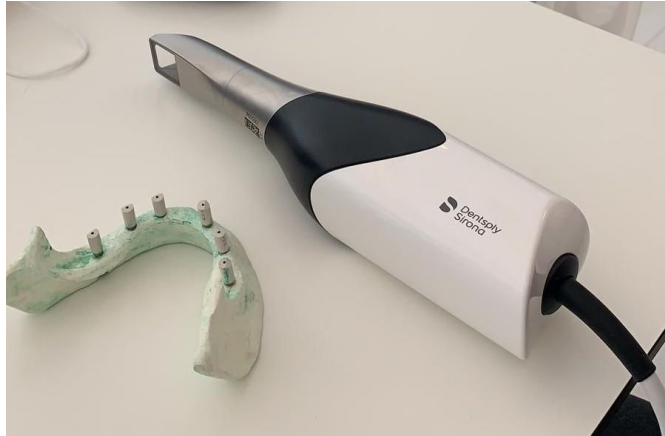
Şekil 14 : Sirona CEREC PrimeScan ağız içi tarayıcı ( Sirona Dental Systems, Bensheim, Almanya)
