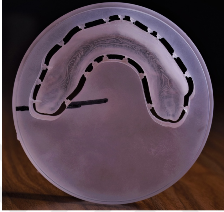
Şekil 2 : Şeffaf akrilik disk bloktan rehber plak üretimi
