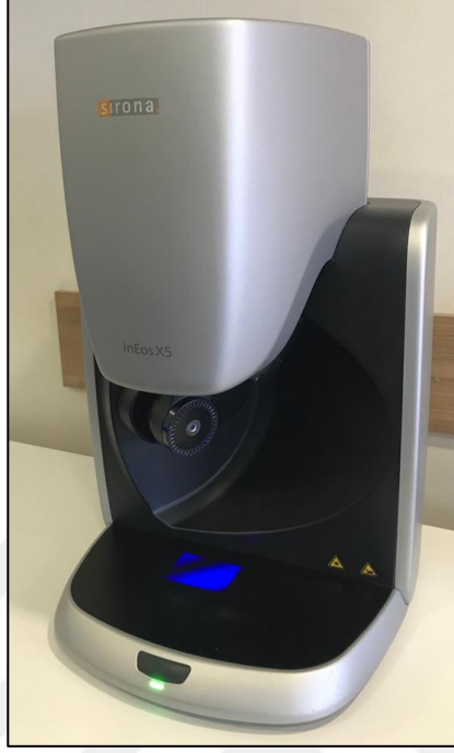
Şekil 12: inEos X5 Laboratuvar Masaüstü Tarayıcısı (Sirona Dental Sistemler, Bensheim, Almanya)
