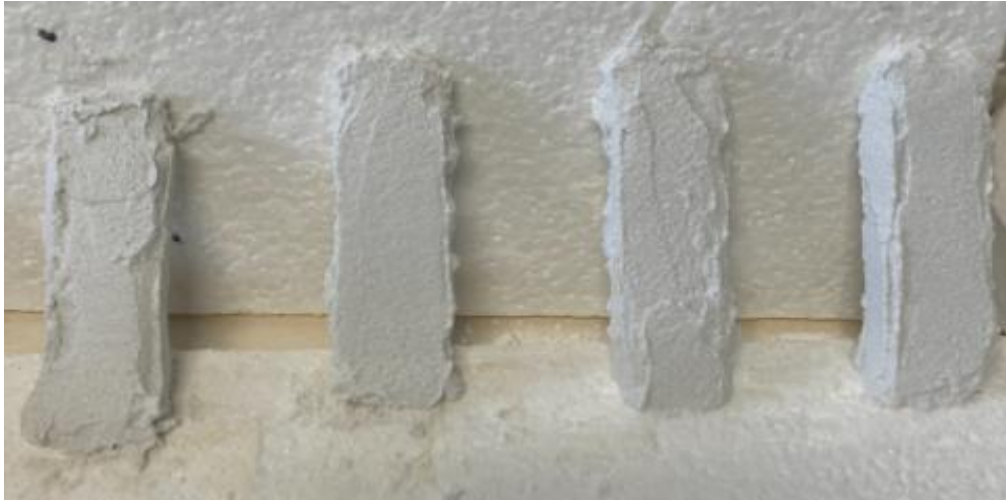
Şekil 2.4. Çamur ile kaplanmış borosilikat cam numuneleri
