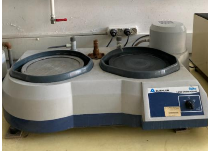
Şekil 2.1. Pah işleminde kullanılan okulumuzdaki taşlama cihazı
