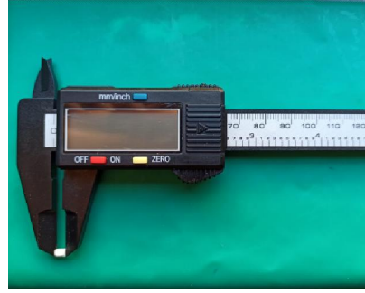
Şekil 3.8.2. Elde edilen numunelerin dijital kumpas ile ölçümü
