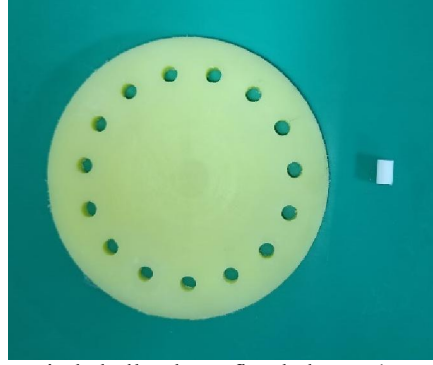
Şekil 3.5.1. Basma dayanımı testinde kullanılan teflon kalıp ve 4 mm çapında-6 mm yüksekliğinde hazırlanan numune
