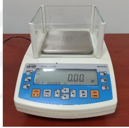
Şekil 3.7.1. Tez çalışmamızda numunelerin kütlelerinin ölçülmesi için kullanılan hassas terazi
