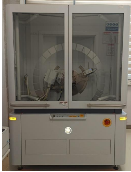
Şekil 3.2.1. X ışını kırınım difraktometresi (Panalytical Empyrean)
