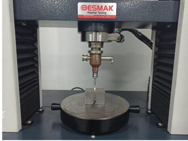
Şekil 3.5.3. Basma dayanımı testinin uygulanması
