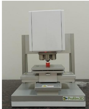
Şekil 3.9.2. Optik profilometre cihazı
