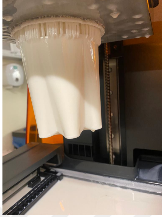
Görsel 2.14. SLA yazıcıda modellemesi tamamlanan ürün Sümeyye Karakuş fotoğraf arşivi
