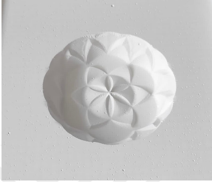
Görsel 3.31. Kazıma işlemi tamamlanan kalıp Sümeyye Karakuş fotoğraf arşivi
