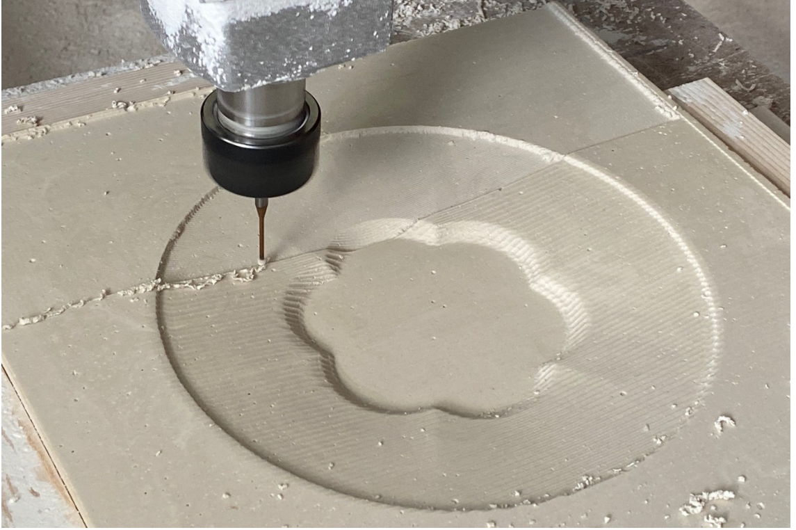
Görsel 2.43. Kaba kazımanın ardından ince kazıma ařaması
