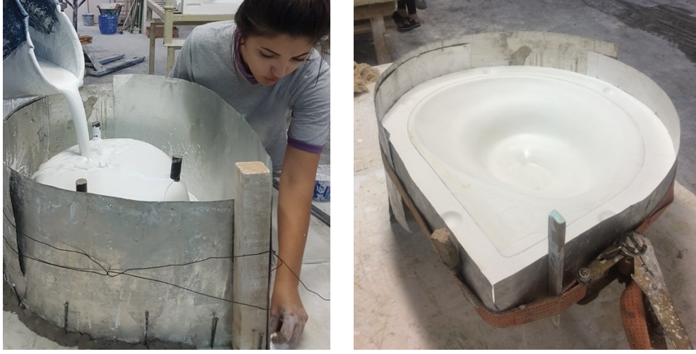
Görsel 2.37. Lavabo modelinin üretim kalıbının yapılması
