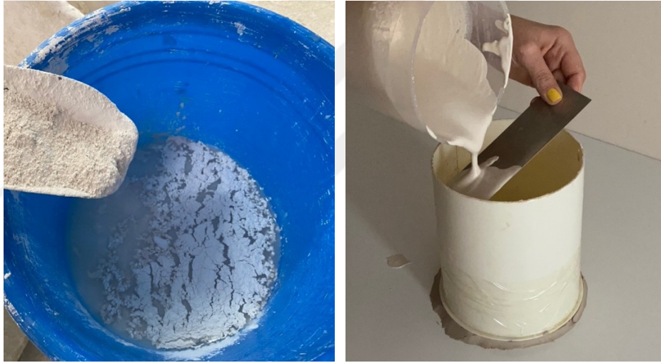
Görsel 3.14. Alçı karışımının hazırlanması ve dökülmesi
