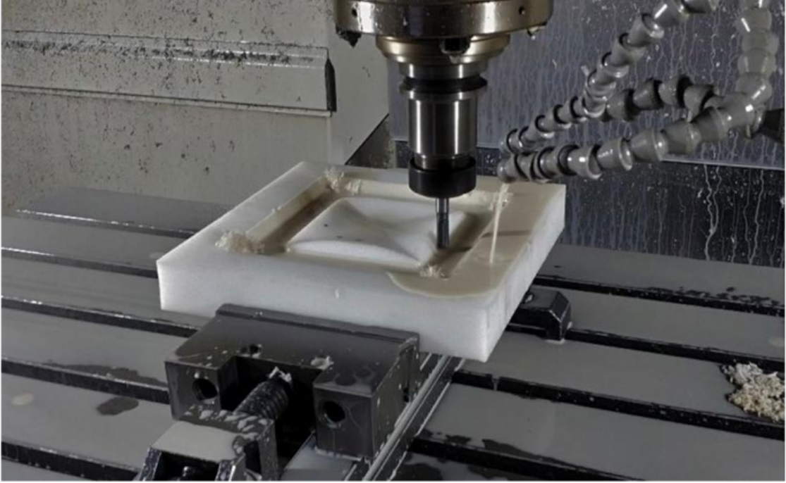
Görsel 2.35. CNC 'de polietilen malzeme ile teksir kalıbı şekillendirme (Erdem, 2018, s.61)
