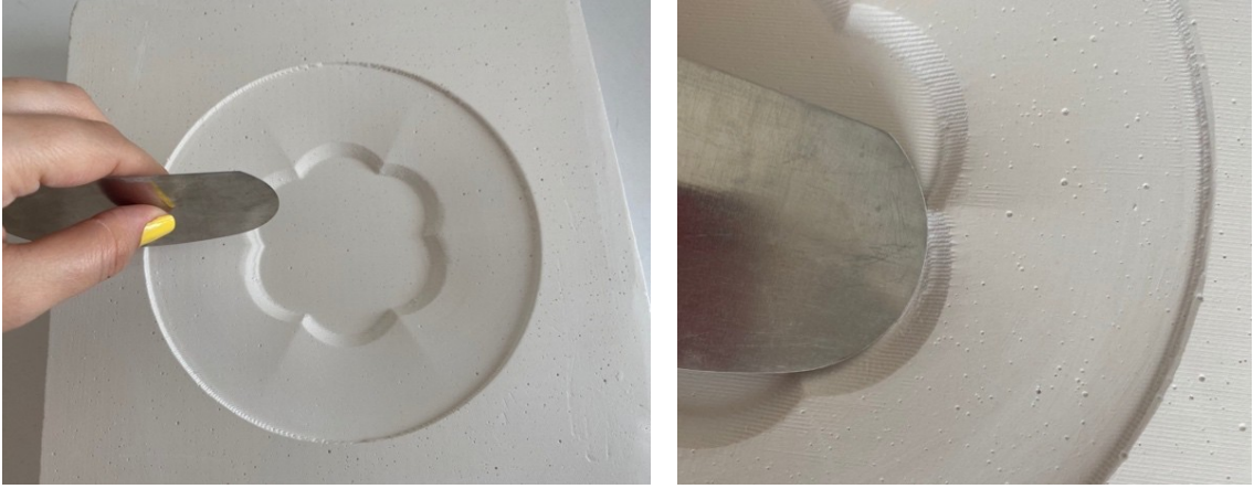
Görsel 3.22. Sistre yardımı ile dokuların giderilmesi
