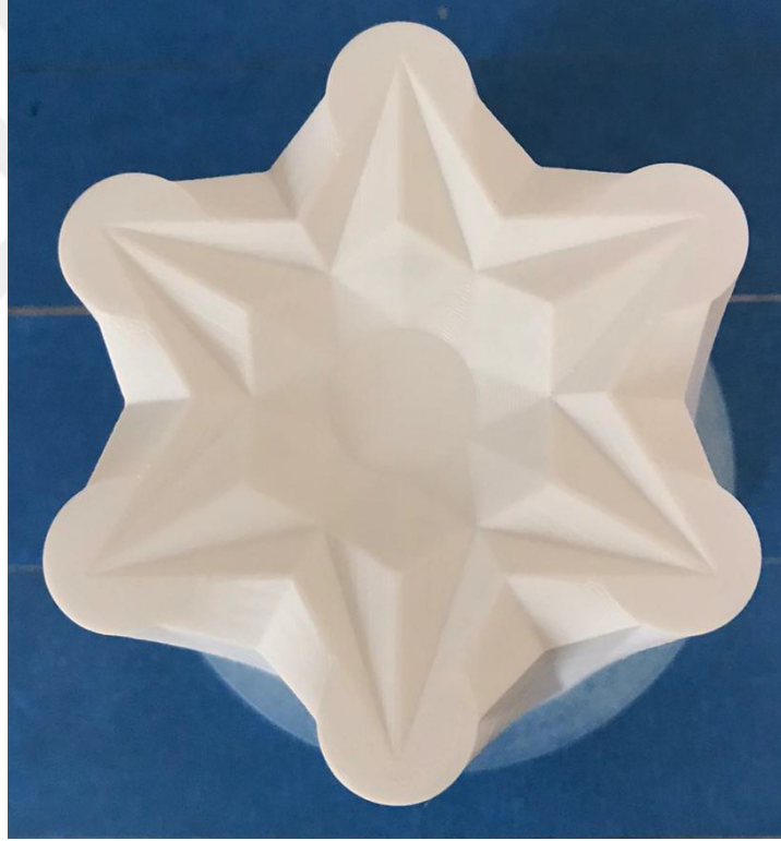
Görsel 2.26. FDM yöntemi ile oluşturulan model Sümeyye Karakuş fotoğraf arşivi
