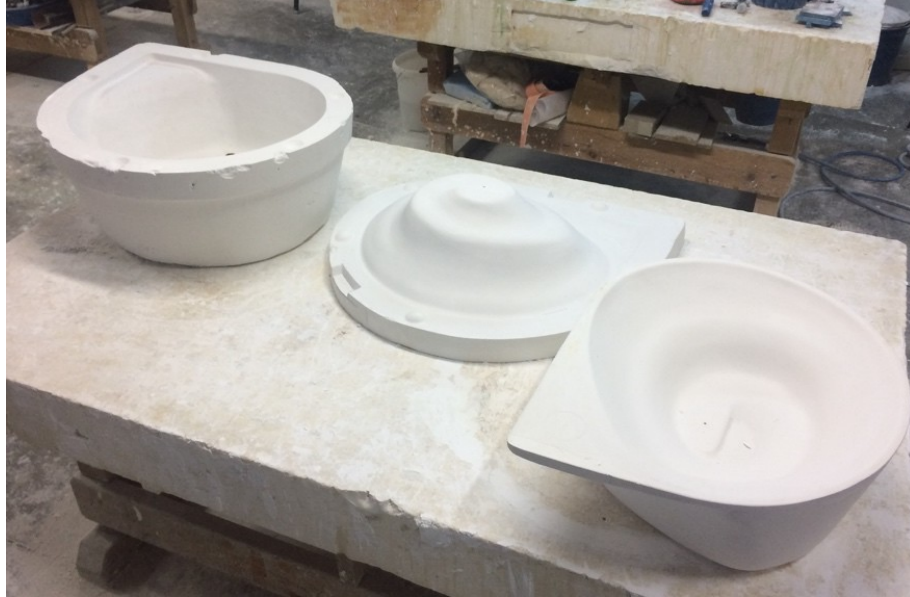
Görsel 2.38. Elle şekillendirilen lavabo modeli ve model ile yapılan üretim kalıpları
