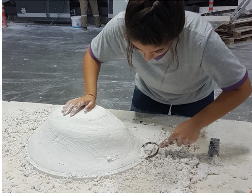
Görsel 2.36. Kütle alçıyı yontarak endüstriyel lavabo modellemesi Sümeyye Karakuş fotoğraf arşivi
