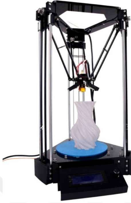
Görsel 2.10. Delta tipi üç boyutlu yazıcı (http-23)
