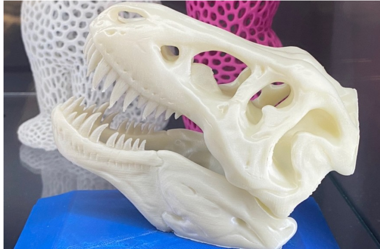
Görsel 2.22. FDM yazıcı ile yapılan baskı örneği Sümeyye Karakuş fotoğraf arşivi
