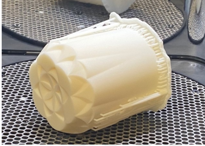
Görsel 2.17. Model üzerinde bulunan yüzey destekleri Sümeyye Karakuş fotoğraf arşivi
