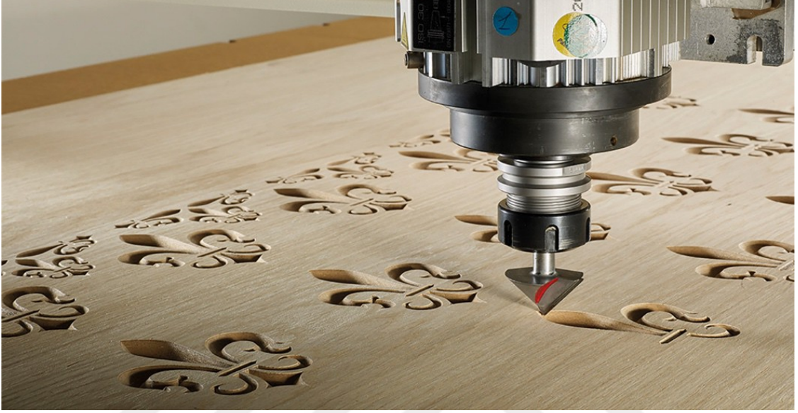
Görsel 1.10. CNC teknolojisi ile ahşap kazıma (http-13)
