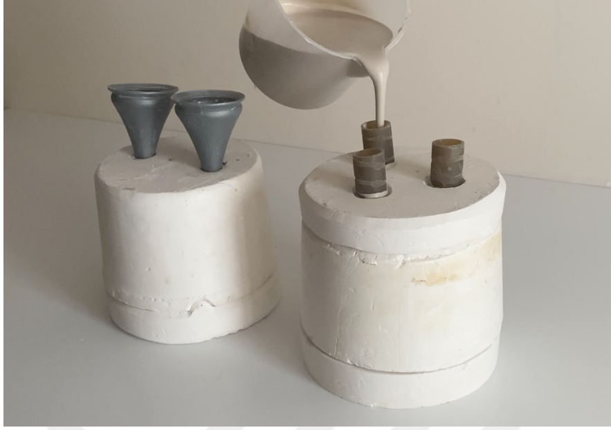
Görsel 3.36. Alçı kalıba çamur döküm aşaması Sümeyye Karakuş fotoğraf arşivi
