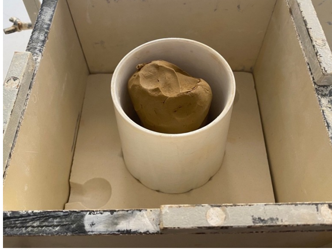
Görsel 3.33. Kalıp çerçevesi hazırlanması Sümeyye Karakuş fotoğraf arşivi
