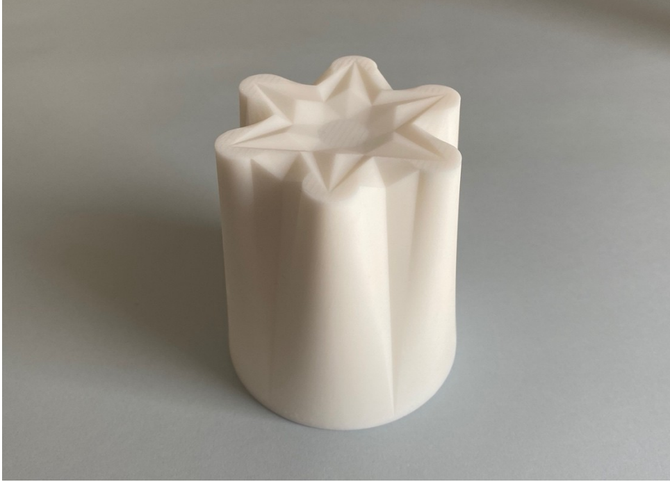
Görsel 2.20. SLA yöntemi ile üretilen model ürün Sümeyye Karakuş fotoğraf arşivi
