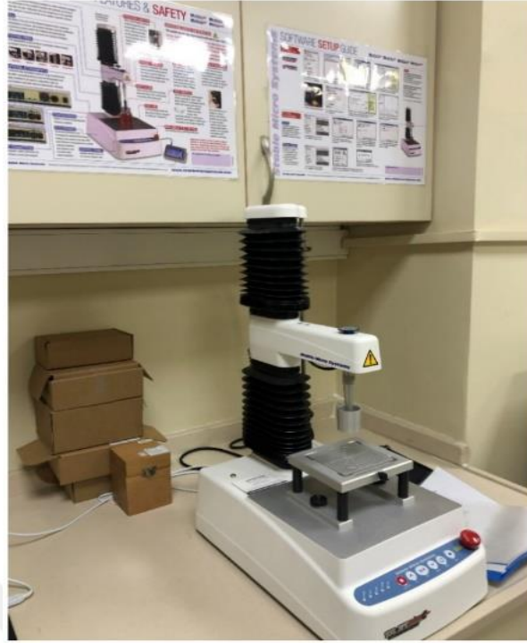
Şekil 3.4 Ekstrüde şeker tekstür analiz cihazı (TPA)
