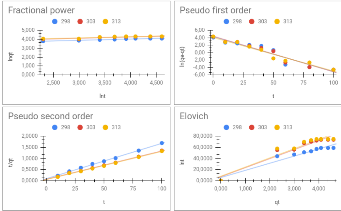
Şekil 4.37. KO kili üzerine KV boyar maddesine ait kinetik grafikleri ( C_0 : 100 ppm, m: 0.1 g, V: 0.1 L).
