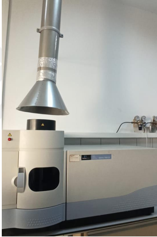
Şekil 3.6. ICP-OES cihazının görseli
