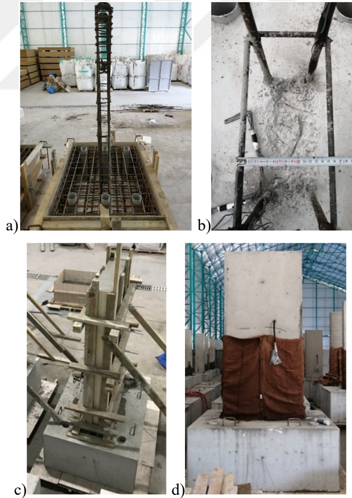
Şekil 2.6 : Numune üretimi: (a) donatı yerleşimi, (b) kolon-temel birleşim yüzeyi, (c)beton dökümü, (d) kürleme işlemi.
