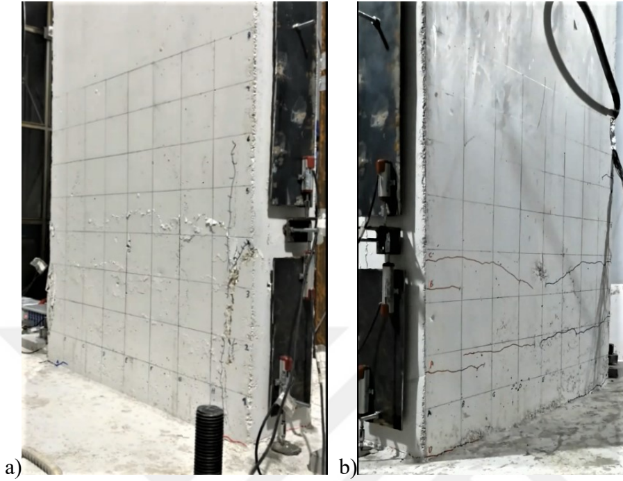
Şekil 2.41 : C-4-60 numunesinin a) doğu b) batı yüzündeki hasar farklılıkları.
