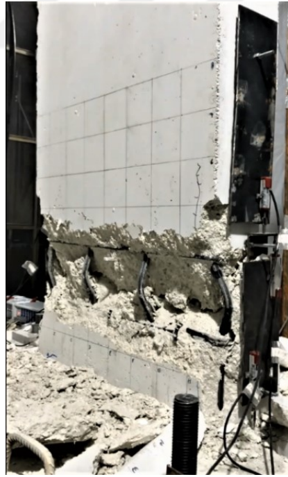
Şekil 2.42 : C-4-60 numunesinin deney sonu fotoğrafı.
