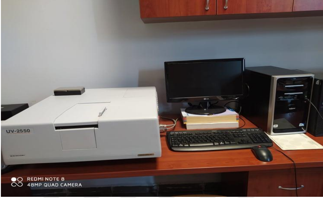
Şekil 5.7 Absorbans spektrum spektrometresi ile aldığı spektrofotometer cihazının fotoğrafı.
