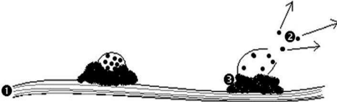
Şekil 2. 13. Tekstil malzemesine uygulanmış koku mikrokapsülünün şematik gösterimi 1-Kumaş, 2- Koku maddesinin salınımı, 3- Çapraz bağlayıcı (Teixeira ve ark., 2011).
