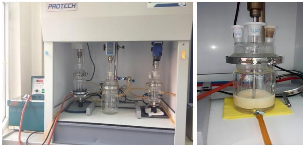
Şekil 3. 3. Mikrokapsül üretimi için hazırlanan üretim düzeneği
