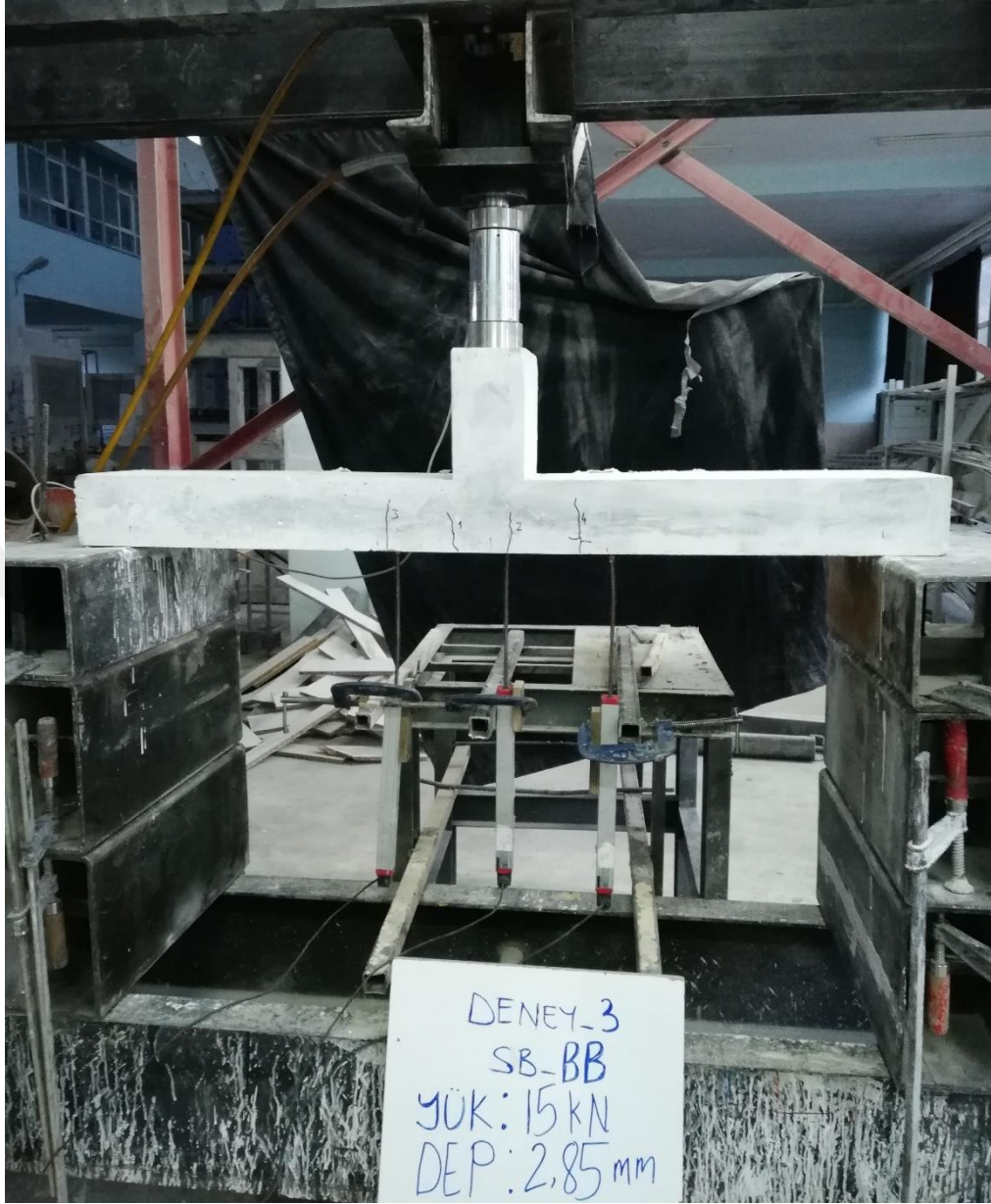
Şekil 4.20. SB-BB numunesinde gözlemlenen ilk çatlak
