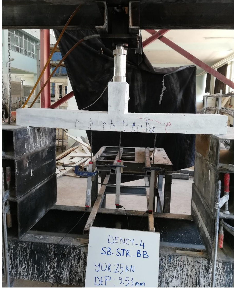
Şekil 4.30. SB-STR-BB numunesinde akma noktasında gözlemlenen çatlak dağılımı
