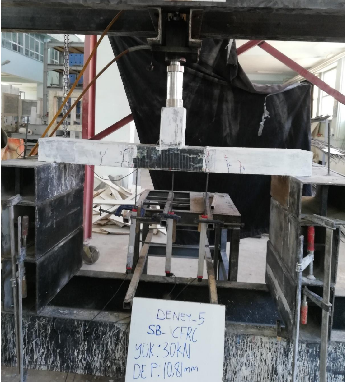
Şekil 4.39 SB-CFRP numunesinde akma noktasında gözlemlenen çatlak dağılımı
