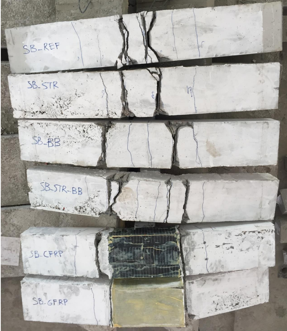
Şekil 4.59. Tüm deney elemanlarının göçmeden sonraki hali
