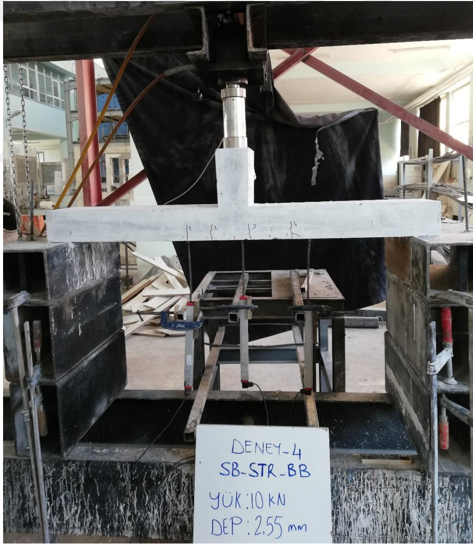
Şekil 4.29. SB-STR-BB numunesinde gözlemlenen ilk çatlak
