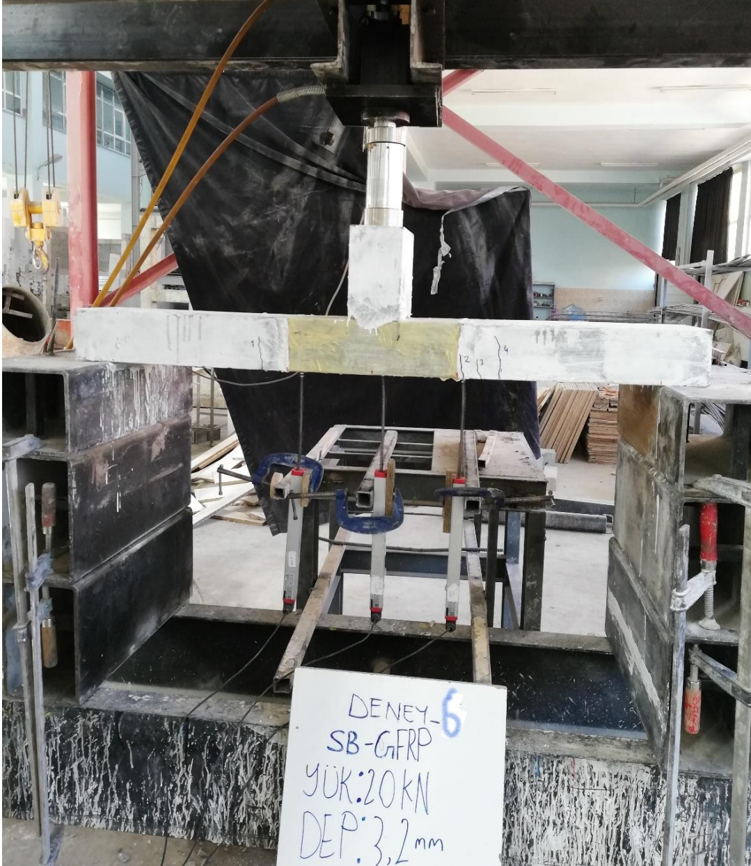
Şekil 4.47. SB-GFRP numunesinde gözlemlenen ilk çatlak
