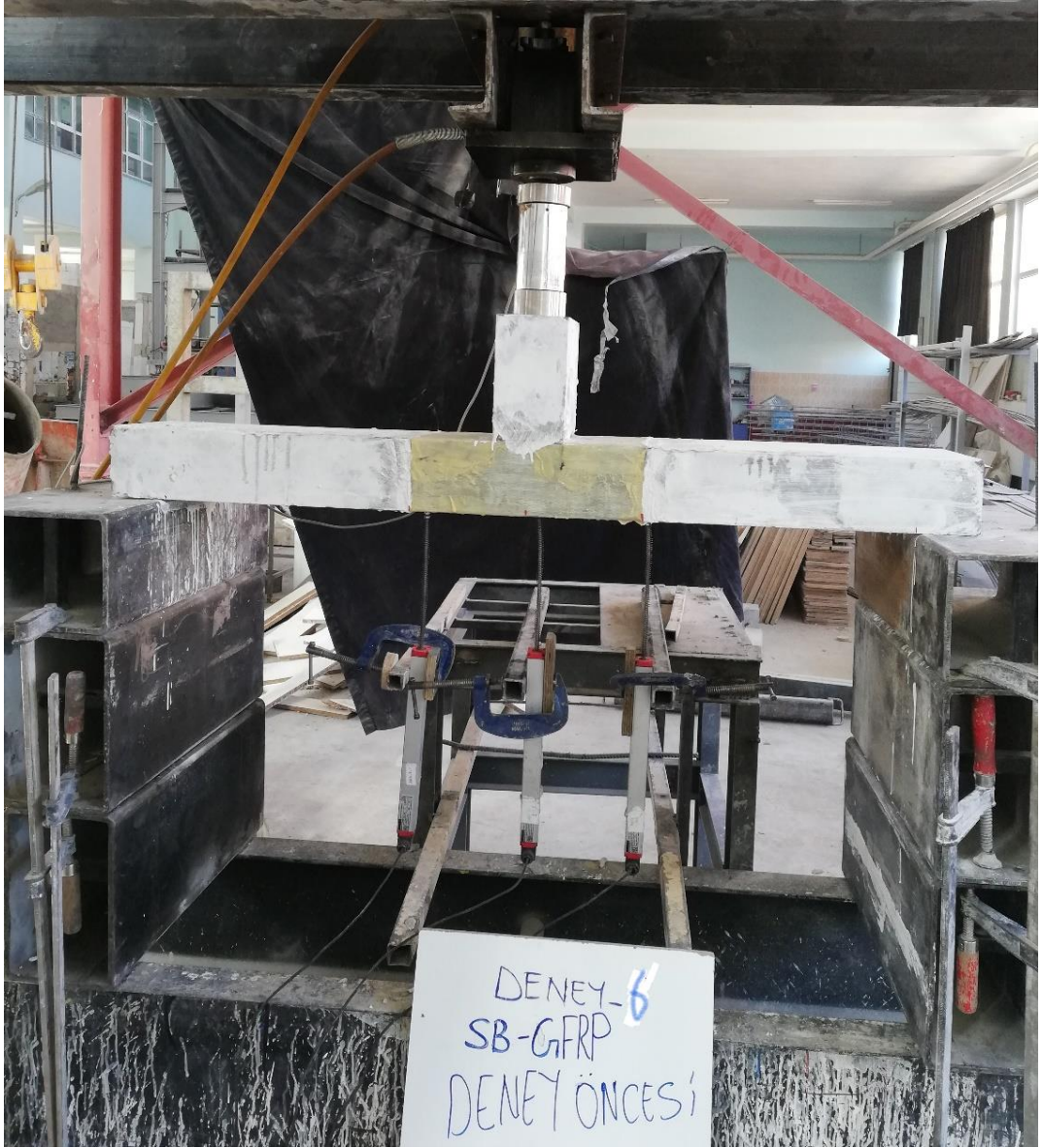
Şekil 4.46. SB-GFRP deney elemanının yükleme öncesi görünümü
