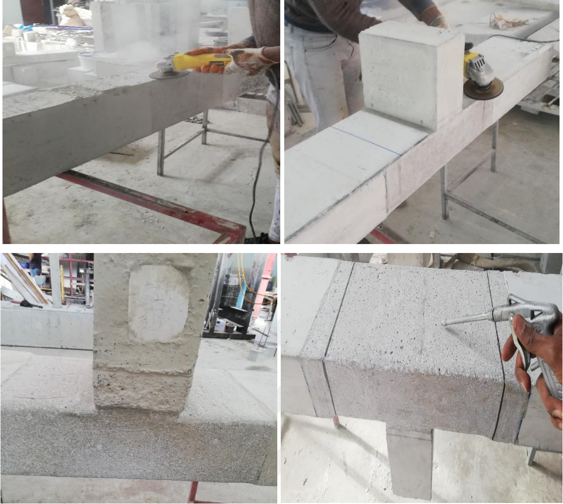
Şekil 3.17. FRP kumaşı ile güçlendirecek olan numunelerin yüzeylerinin hazırlanması
