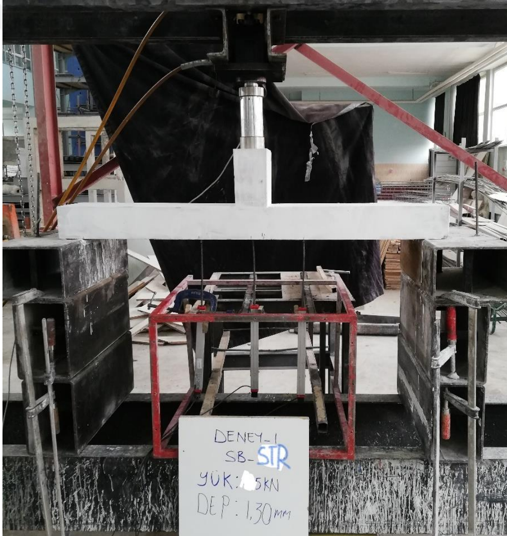
Şekil 4.11. SB-STR numunesinde gözlemlenen ilk çatlak
