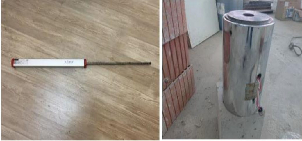
Şekil 3.25. Deneylerde kullanılan potansiyometrik cetvel ve yük hücresi
