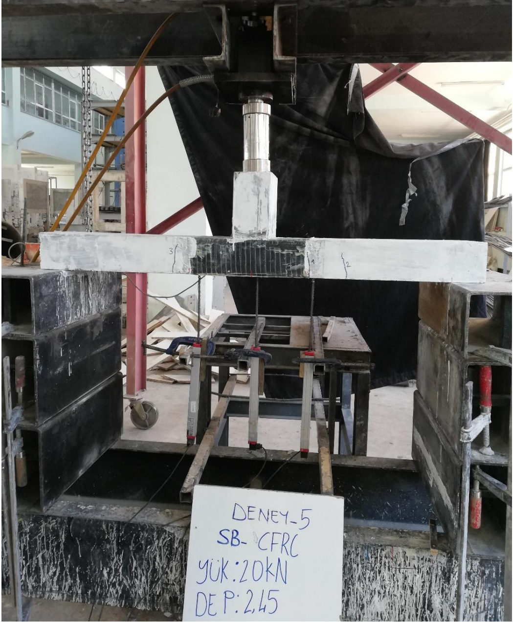
Şekil 4.38. SB-CFRP numunesinde gözlemlenen ilk çatlak
