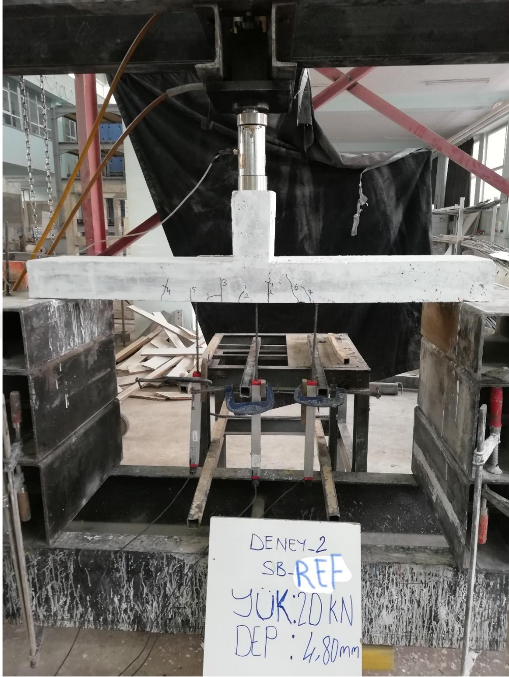
Şekil 4.3. SB-REF numunesinde akma noktasında gözlenen çatlak dağılımı
