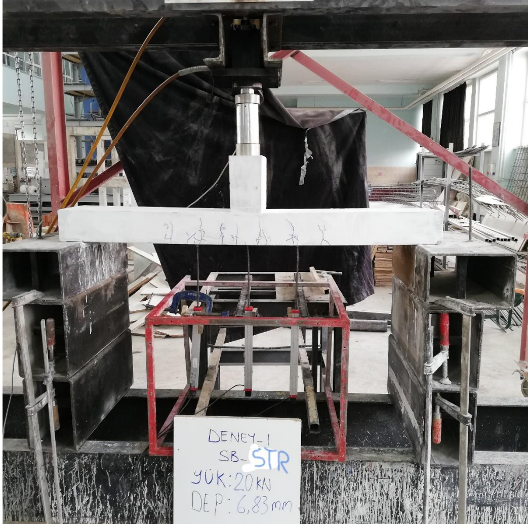
Şekil 4.12 SB-STR numunesinde akma noktasında gözlemlenen çatlak dağılımı
