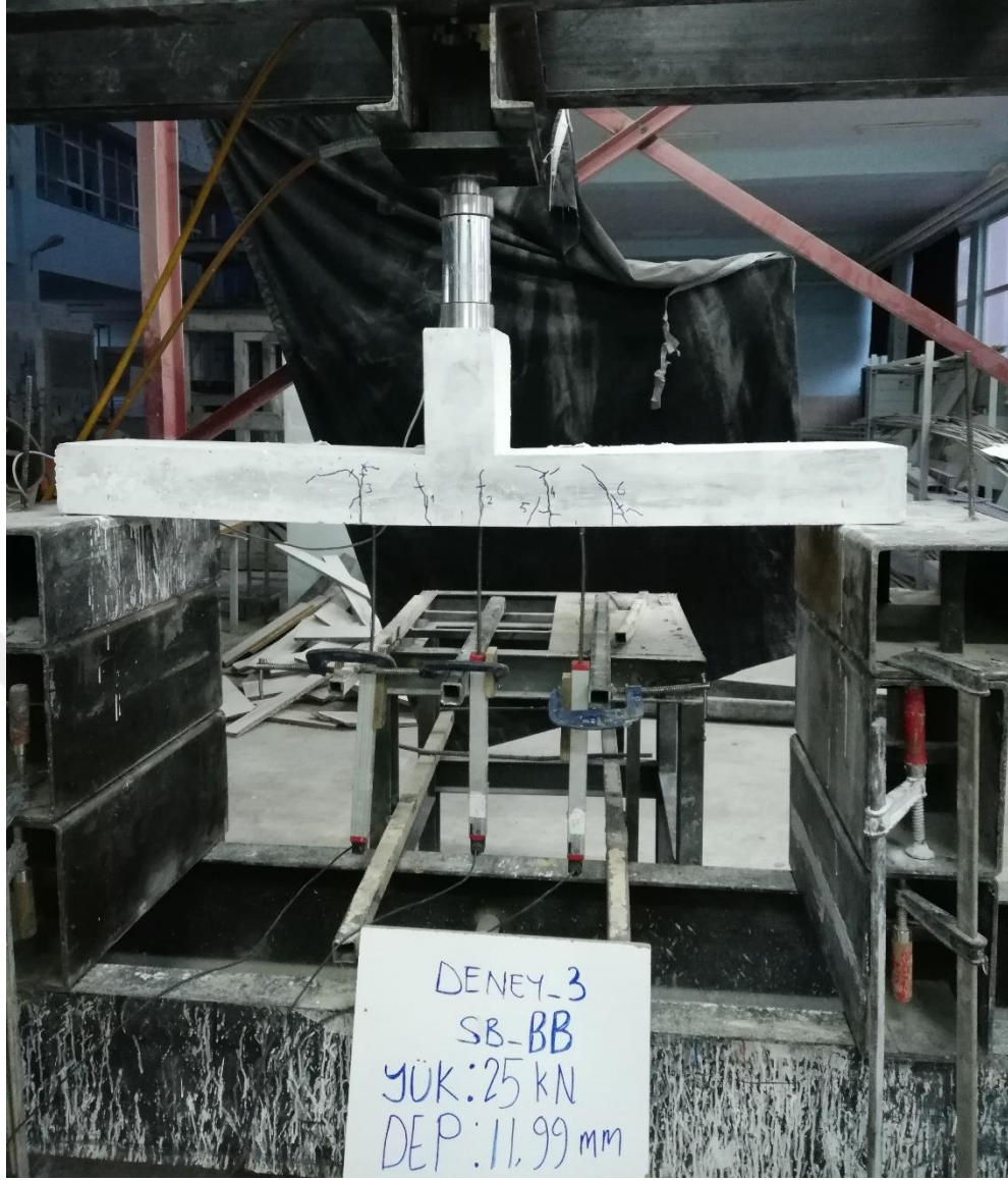
Şekil 4.21. SB-BB numunesinde akma noktasında gözlemlenen çatlak dağılımı
