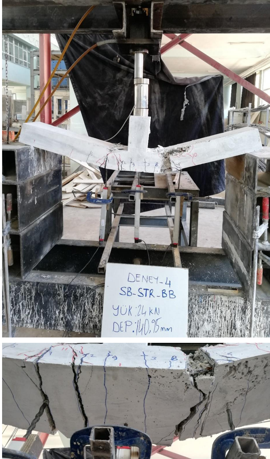
Şekil 4.32. SB-STR-BB deney elemanının göçme anındaki görüntüsü
