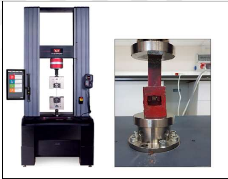
Resim 4-12. a) Evrensel Instron makinesi. b) Bağlantıların kesme testi için tasarlanmış ek donanımın
