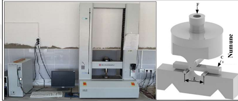
Resim 4-10. Üç nokta eğme testi için universal çekme makinesi. numune
