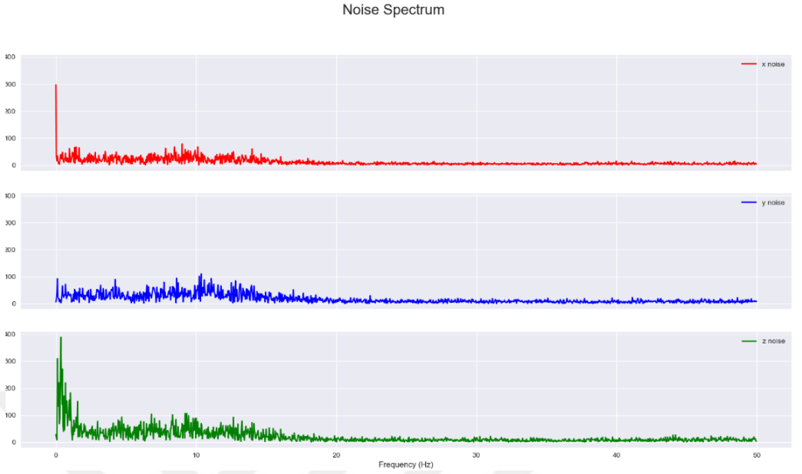
Şekil 4.11. 10 DOF IMU Sensörü gürültü sinyallerinin sönümlenmesi grafiği
