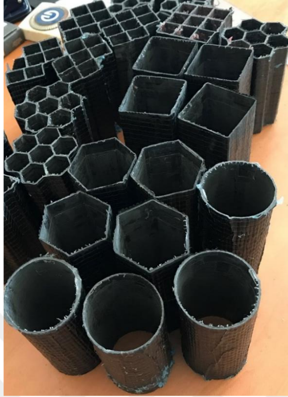
Şekil 2.10. Kare, altıgen ve daire dış kesitli içi boş KETP kompozit çarpışma kutuları ve hücre dolgu kısımları
