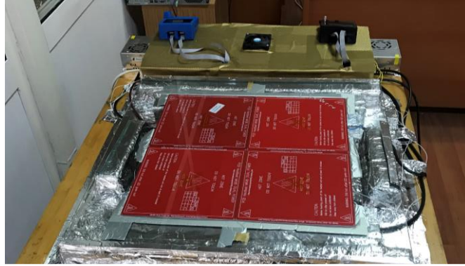
Şekil 2.1. Kompozit plakaların üretimi için imal edilen ısıtma sistemli vakum infüzyon düzeneğinin genel görünüşü
