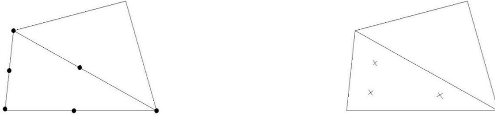
Şekil 4.5. 6 Düğüm Noktalı Üçgen Elemanda Düğümler ve Gerilme Noktaları (PLAXIS 2D CONNECT Edition V21, 2021)
