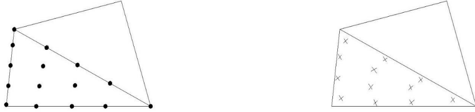
Şekil 4.4. 15 Düğüm Noktalı Üçgen Elemanda Düğümler ve Gerilme Noktaları (PLAXIS 2D CONNECT Edition V21, 2021)
