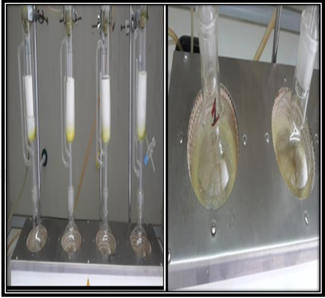
Şekil 3.17 Soxholet cihazında yağ çıkarma işlemi
