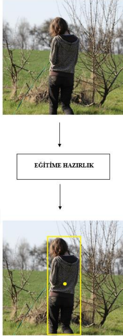
Şekil 32. YOLO ağı için “insan” sınıfı eğitim verilerinin hazırlanması
