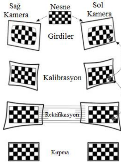
Şekil 8. Stereo düzeltme: rektifiye edilmiş görüntüler (Bradsky ve Kaehler, 2008)
