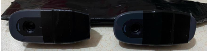
Şekil 45. Uygulama kapsamında oluşturulan stereo kamera sistemi
