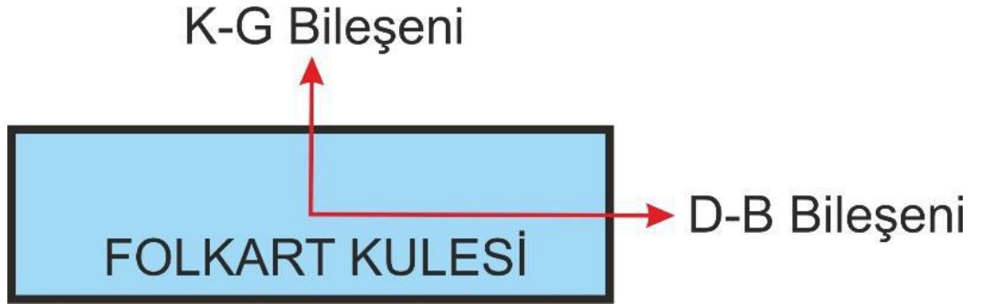
Şekil 5.3 Mikrotremor bileşenlerinin ölçüm doğrultuları
