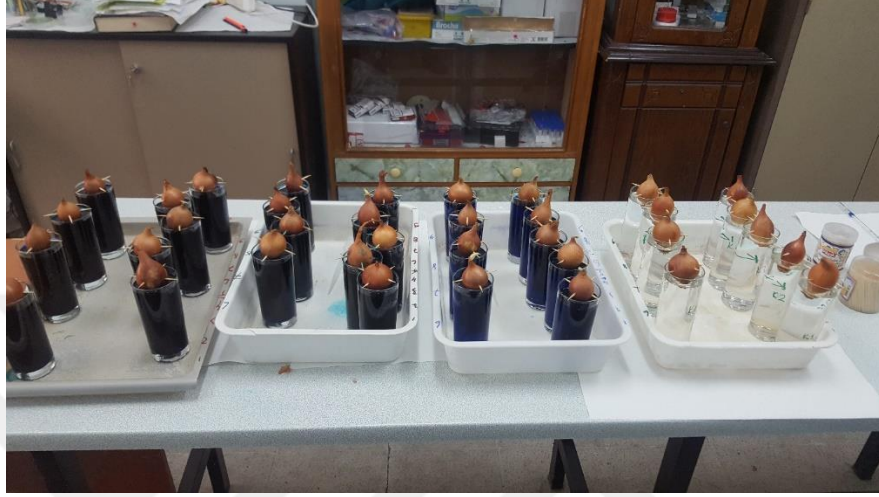
Şekil 2.3. Üç farklı konsantrasyonda boya çözeltisi ve kaynak suyu içeren deney düzeneklerindeki soğan örnekleri.
