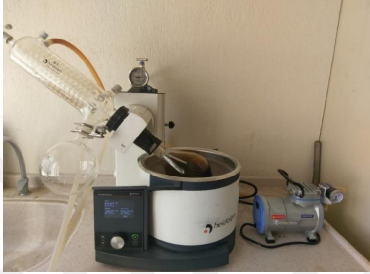
Resim 3.12 Diklorometanın ayrıştırma işlemi.
