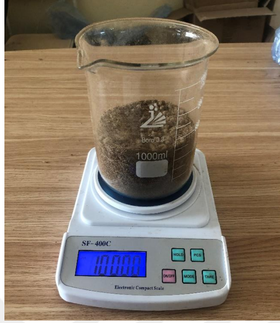
Resim 3.8 Numunelerin hassas terazide tartılması işlemi.
