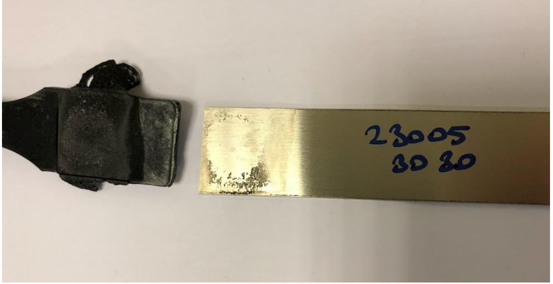
Şekil 4. 1: 230 °C ve 5 bar basınçta gerçekleştirilen deney numunesi.
