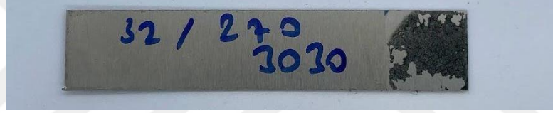
Şekil 4. 9: 270 °C, 2 bar ve t_h = 30 s'de gerçekleştirilen test numunesi.
