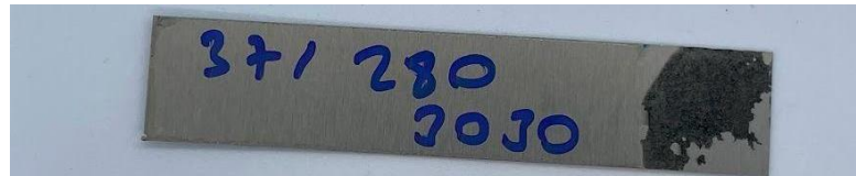
Şekil 4. 10: 280 °C, 2 bar ve t_h = 30 s'de gerçekleştirilen test numunesi.
