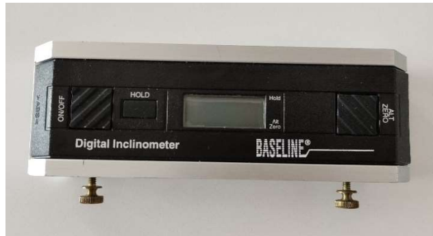
Şekil 3.4. Baseline Dijital İnklinometre
