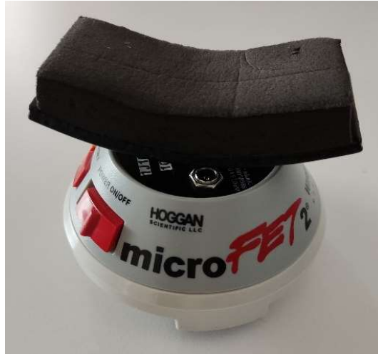
Şekil 3.7. Hoggan MicroFET2 El Dinamometresi
