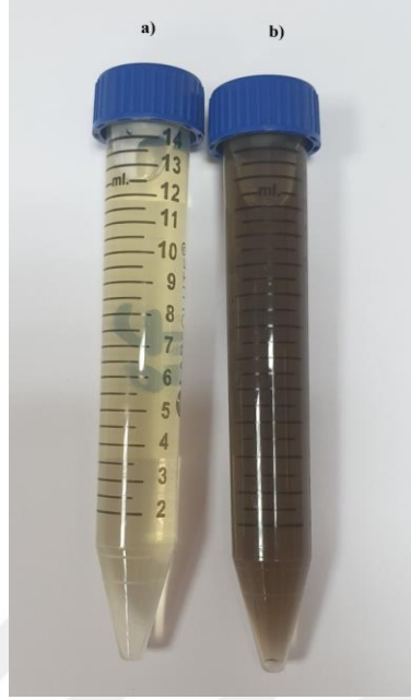
Şekil 3.3. a) Bitki özütü b) Gümüş nanopartiküllerin oluşması esnasında gözlemlenen renk değişimi
