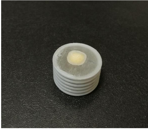
Resim 2.1. Plastik kalıba gömülmüş ve plastik kalıptan çıkarılmış örnek
