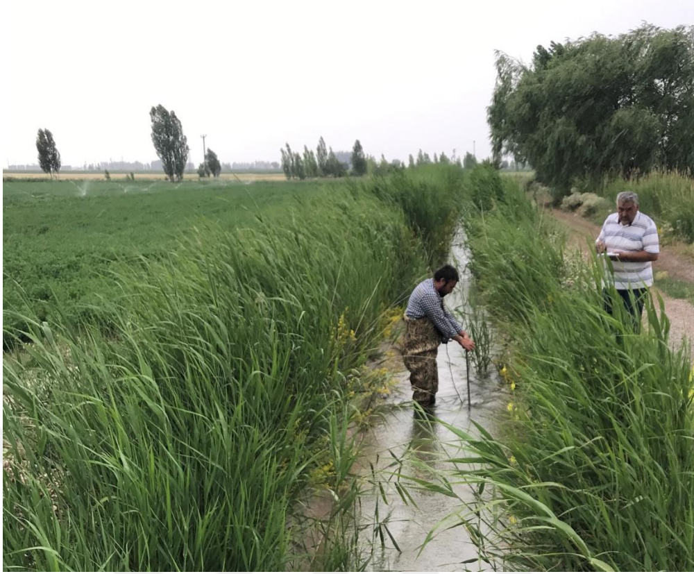
Şekil 4.13. Tersiyer kanallarda muline ile ölçüm yapılması
