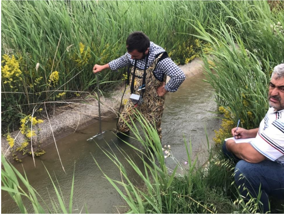
Şekil 4.12. Tersiyer kanallarda muline ile ölçüm yapılması
