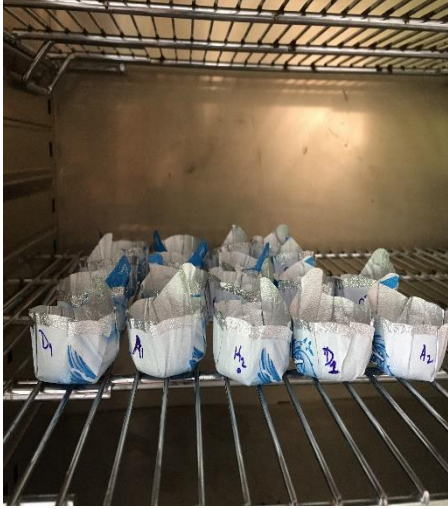
EK 4. Yoğurt Örneklerinde Yapılan Kuru Madde ve Kül Tayini
