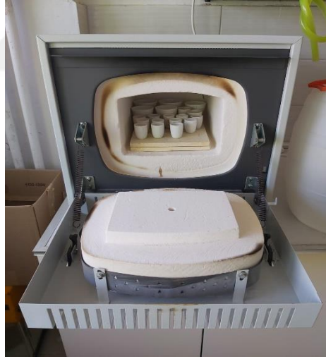
EK 4. Yoğurt Örneklerinde Yapılan Kuru Madde ve Kül Tayini
