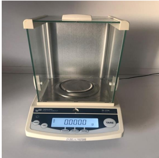
Şekil 6. Ağırlık ölçümü için kullanılan hassas terazi (Sartorius Denver Hassas Terazi, Sartorius, Goettingen, Almanya).
