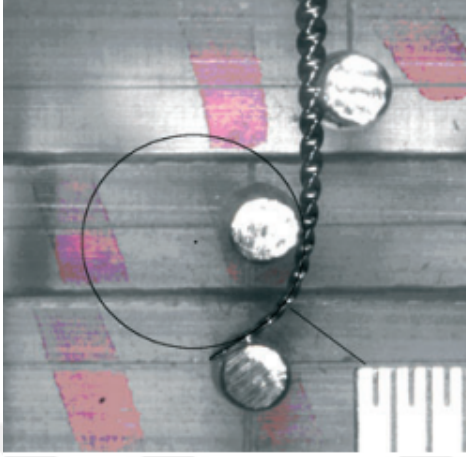
Şekil 2.24. Dönen bir eğeyi üç noktada eğilendiren düzenek (1)
