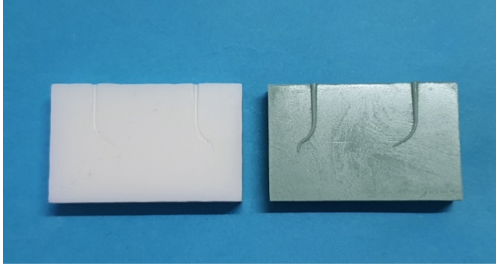
Şekil 3.5. 0,06 taper açısı ile hazırlanan seramik blok ve silikon ölçü materyali ile hazırlanan dublike görüntüsü
