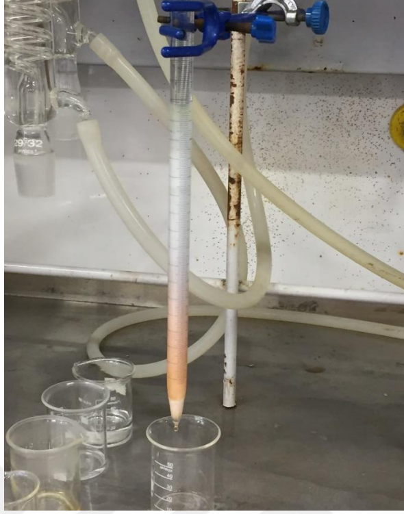
Şekil 2.4. Kolon kromatografisi ile pigment saflaştırılması
