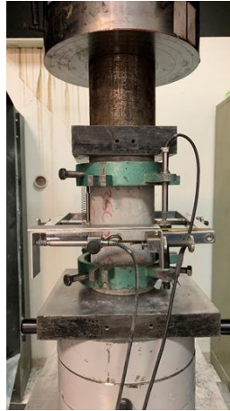
Şekil 3.7 : Mekanik test (Elastisite modülü) düzeneği.
