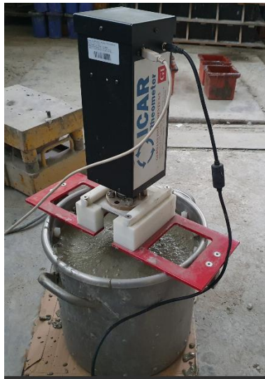
Şekil 3.2 : ICAR reometresi deney düzeneği.
