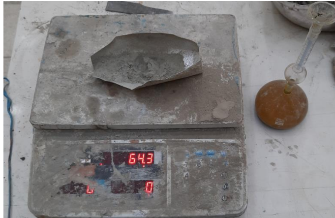
Şekil 2.5 : Beton karışımlarında kullanılan çimentonun özgül ağırlık ölçümü.
