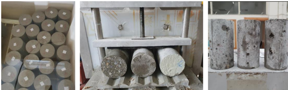
Şekil 3.5 : 100 mm çapında ve 200 mm uzunluğundaki silindirik numuneler.
