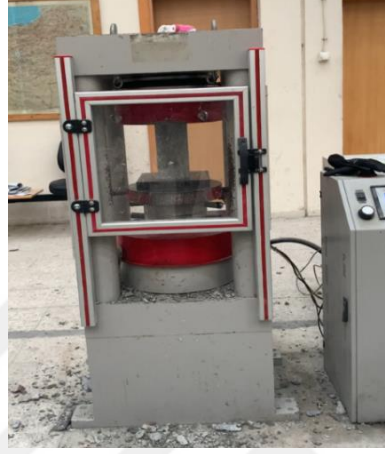
Şekil 3.6 : Basınç dayanımı test düzeneği.
