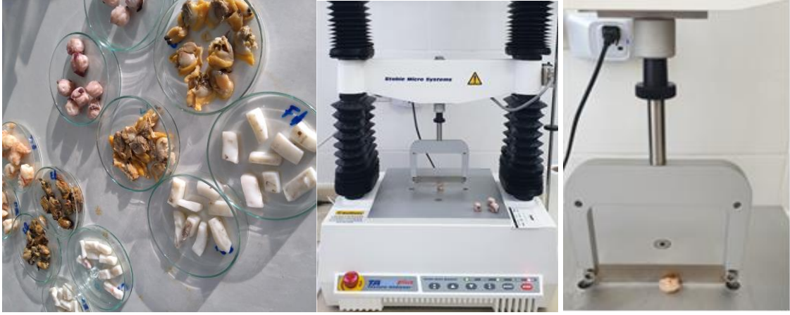
Şekil 3.4. Su ürünleri örnekleri ve TA-XT Plus Texture Analyser cihazı
