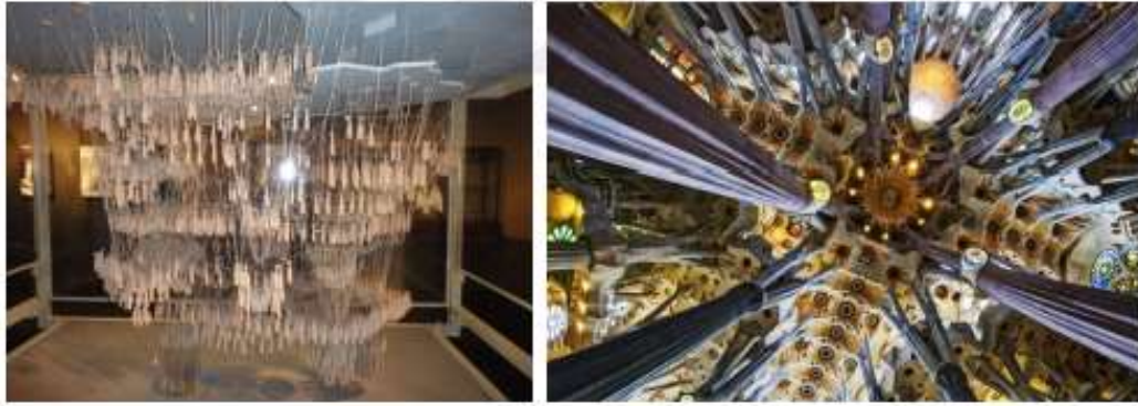
Şekil 2.7. (a) Antoni Gaudi’nin tasarım geliştirmede kullandığı Sagrada Familia’nın asma zincir modeli (ters çevrilmiş katener kemeri), (b) Sagrada Familia’nın ağaç yapıları ve ters katener model kombinasyonundan esinlenen iç yapısı
