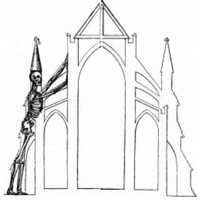
Şekil 2.6. Gotik tonozların karşı-dayanaklarını insan iskeleti ile karşılaştıran diyagram. Pratik Mimari Spesifikasyonlarından
