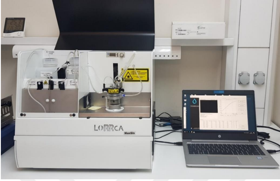
Şekil 3. 2: Lazerli ektasitometre cihazı SBÜ Hamidiye Tıp Fakültesi Hemoreoloji Araştırma Laboratuvarında çekilmiştir.
