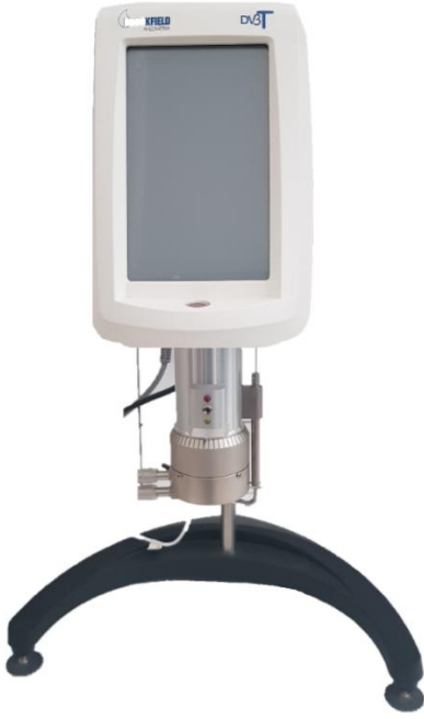
Şekil 3. 7: Cone-plate viskozimetre cihazı SBÜ Hemoreoloji Laboratuvarında çekilmiştir.
