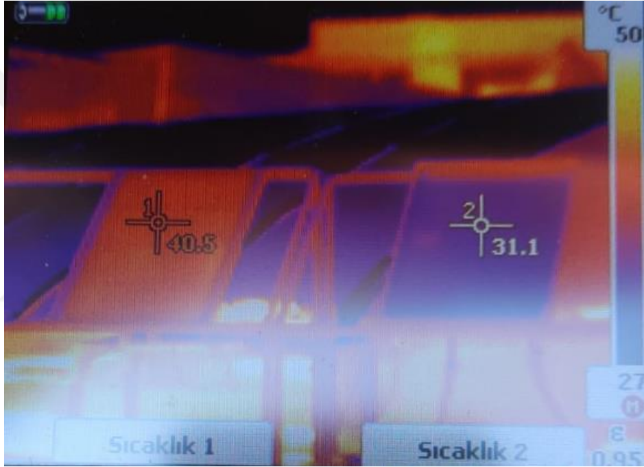
Şekil 7.15. Levha kanatçıklı su soğutmalı ve kanatçıksız-soğutmasız panele ait termal kamera görüntüsü
