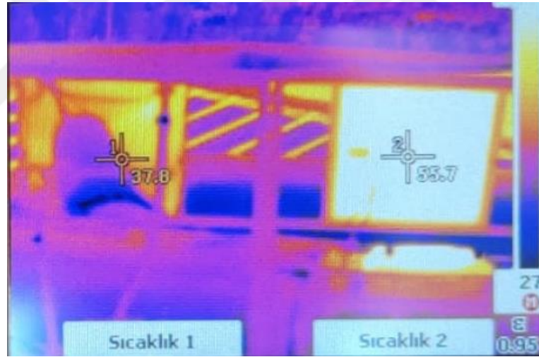
Şekil 7.24. Ağırlıkça %0,4 oranında levha kanatçıklı Al_2O_3 -su nanoakışkan soğutmalı ve soğutmasız panellere ait arka taraftan çekilen termal kamera görüntüsü
