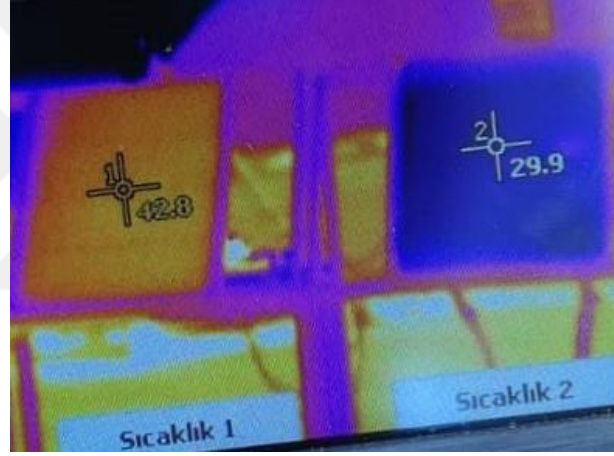
Şekil 7.39. Ağırlıkça %0,4 oranında levha kanatçıklı \text{TiO}_2 -su nanoakışkan soğutmalı ve soğutmasız panellere ait ön taraftan çekilen termal kamera görüntüsü
