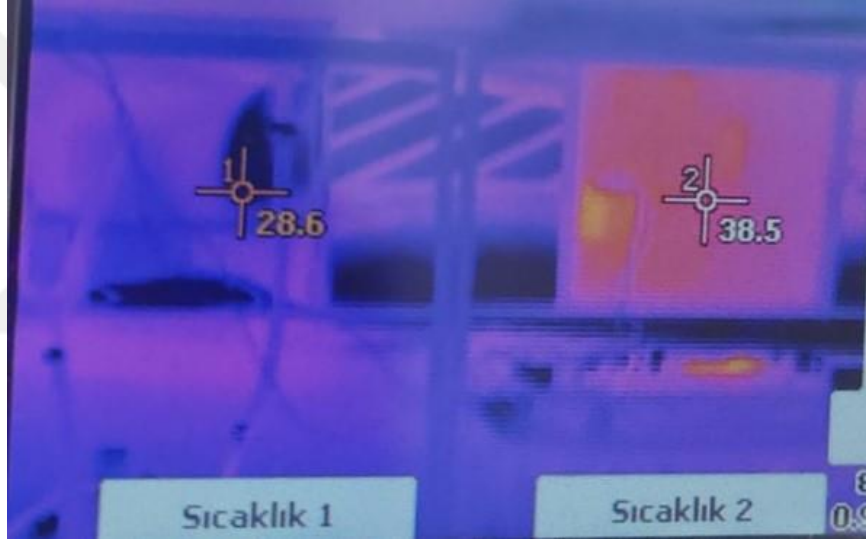
Şekil 7.58. Ağırlıkça %0,4 oranında levha kanatçıklı CuO-su nanoakışkan soğutmalı ve soğutmasız panellere ait arka taraftan çekilen termal kamera görüntü
