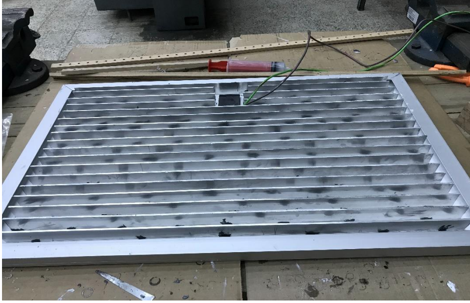
Şekil 6.3. Levha kanatçıkların panele yapıştırılması
