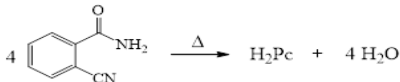
Şekil 2.2: o-siyanobenzamid sentezi sırasında metalsiz ftalosiyanin eldesi [11].
