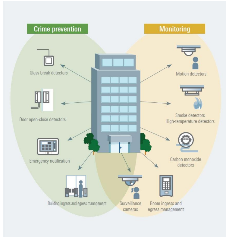
Şekil 2.4 Bina için güvenlik sistemleri [42]
