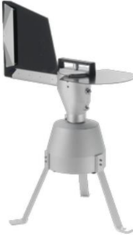
Şekil 2.1. Volumetrik polen ve partikül örnekleme Lanzoni (VPPS 2000) cihazı
